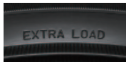
タイヤの幅、扁平率、インチ数が同じでも、最大荷重を表すロードインデックス (LI) はXL規格の方が高くなります。
